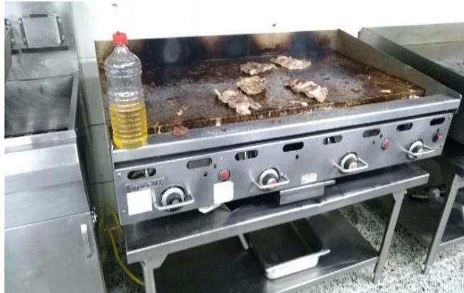
Con un total de 6 mantenimientos correctivos es el equipo al cual se debe priorizar los mantenimientos preventivos debido a que el uso que se le da por parte del operario no es el óptimo.
