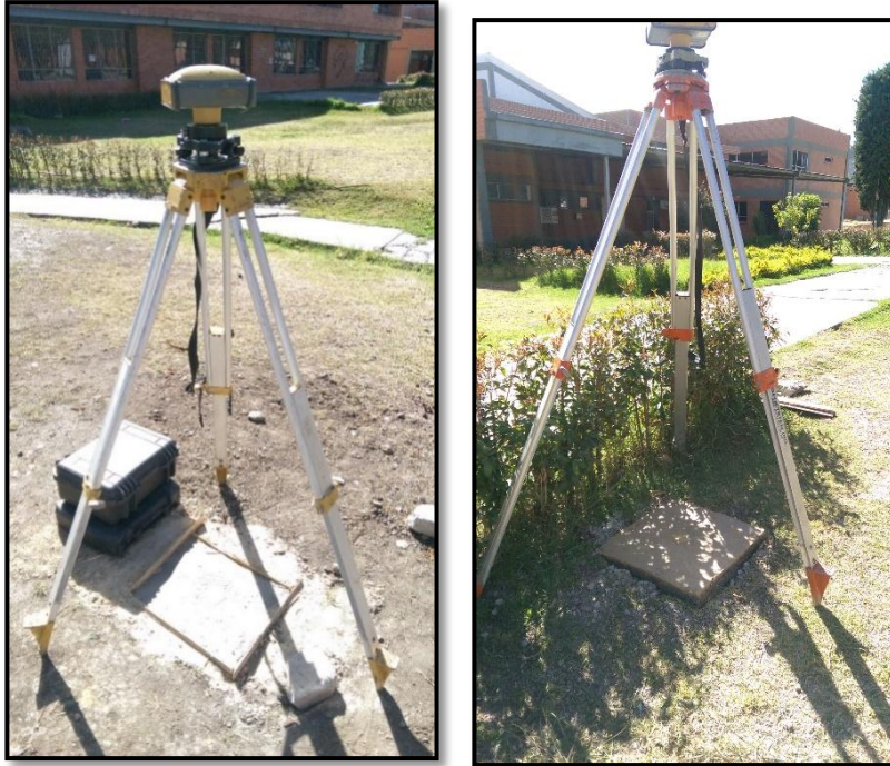
Fotografía 2 . Receptores de señal satelital doble frecuencia
