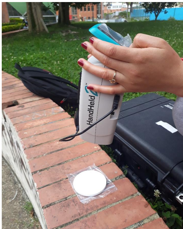
Ilustración 17 Calibración del espectroradiómetro con el spectralón.
