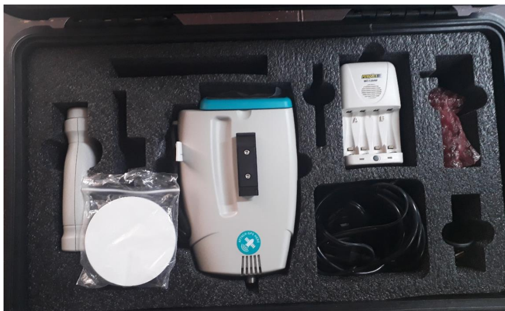
Ilustración 15 Equipo completo de espectroradiometría (Fuente propia).
