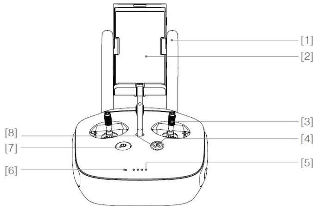
[1] Antenas. Transmiten el control de la aeronave y la señal de vídeo.
