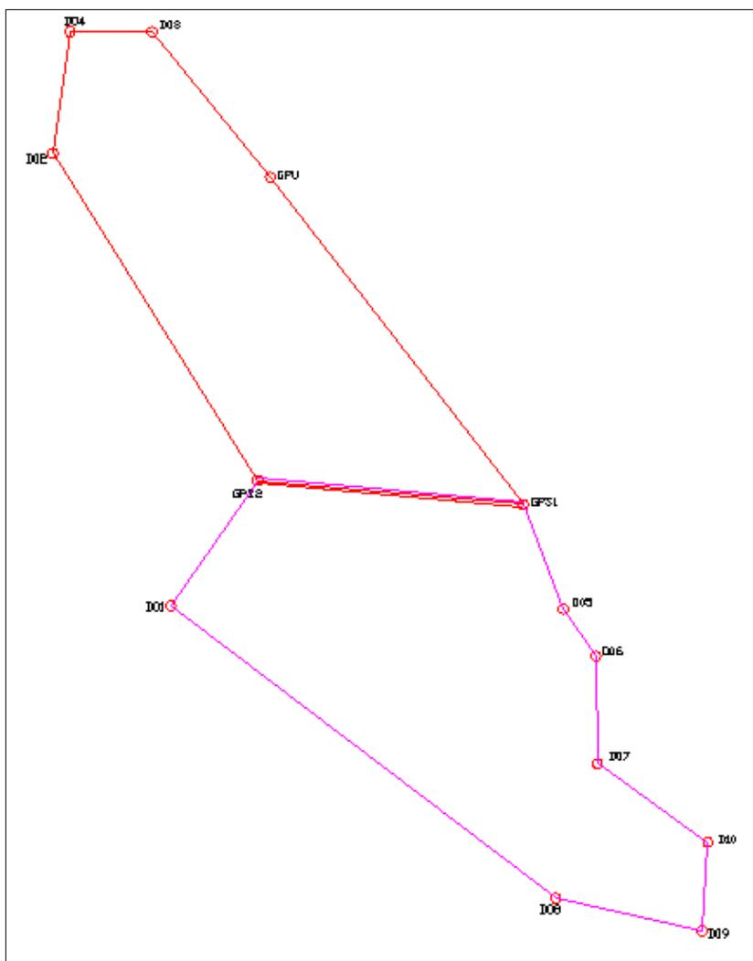
Imagen 20 Poligonales resultantes del levantamiento topográfico.
