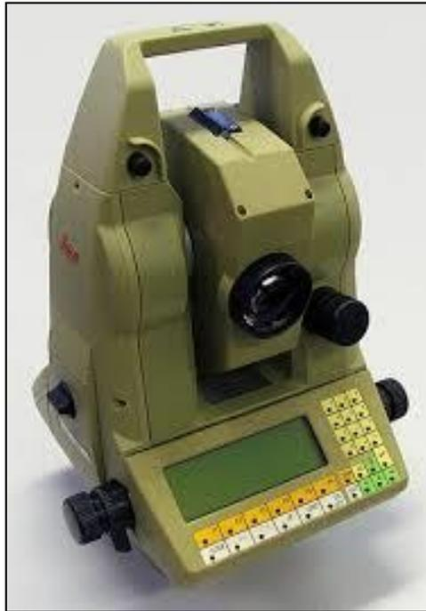
Imagen 9 Estación Leica TC 605 L utilizada en campo
