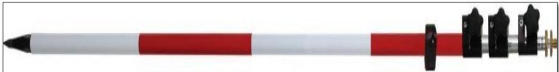
Son básicamente tubos rectos de algún material rígido en su mayoría de aluminio y con un patrón de pintura visible que permita su ubicación y el cálculo aproximado de su longitud, en su base presentan una punta de acero resistente y en su parte superior un tornillo estándar que permite la instalación de prismas, antenas GPS u otros accesorios útiles en trabajos de topografía.
