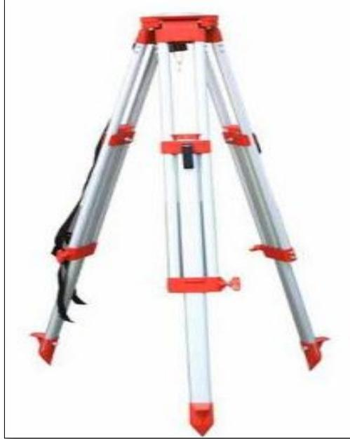
Es el soporte para diferentes instrumentos de medición como teodolitos, estaciones totales, niveles o tránsitos. Cuenta con tres pies de madera o metálicas que son extensibles y terminan en regatones de hierro con estribos para pisar y clavar en el terreno. Deben ser estables y permitir que el aparato quede a la altura de la vista del operador 1,40 m - 1,50 m. Son útiles también para aproximar la nivelación del aparato.
