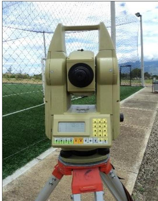
Es un aparato electro-óptico, el cual permite realizar mediciones muy precisas por medio de un distanciómetro incorporado a un teodolito electrónico con un microprocesador.
