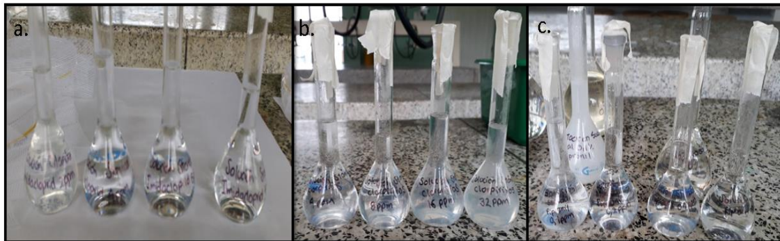
Figura 23. Soluciones estándar, a. soluciones standar imidacloprid; b. soluciones estandar clorpirifos; c. soluciones estándar fipronil.
