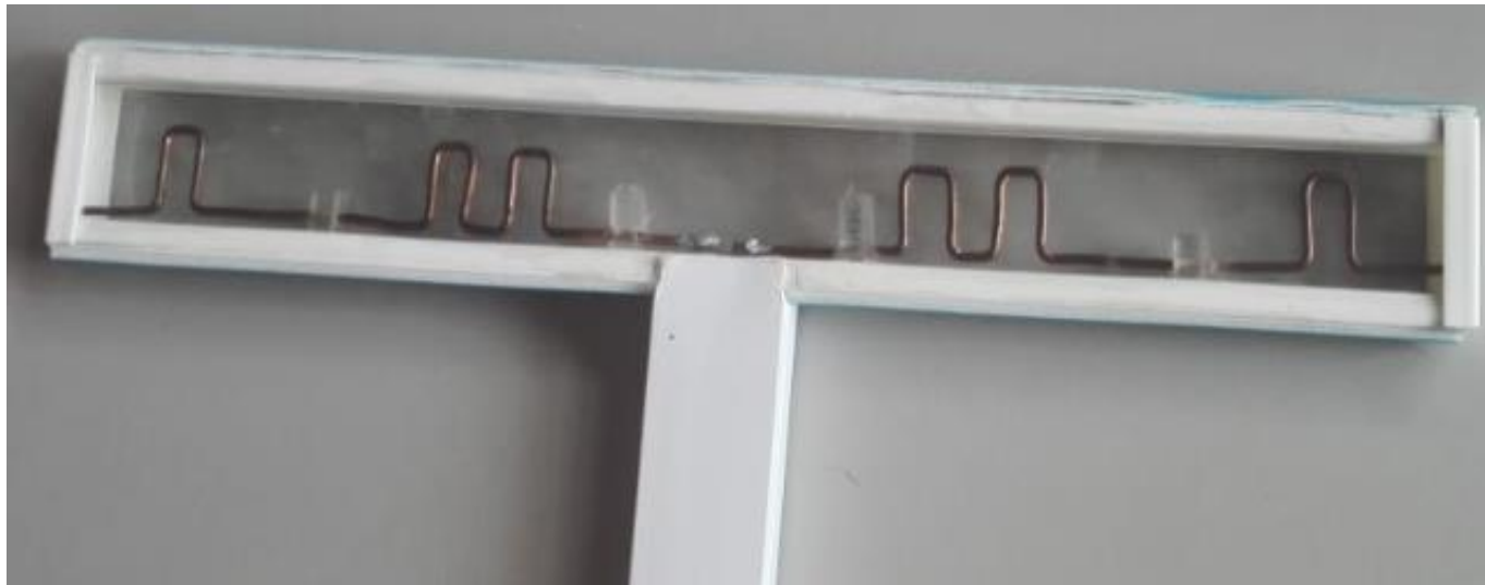
FIGURA 10. ANTENA FRANKLIN CONSTRUIDA
