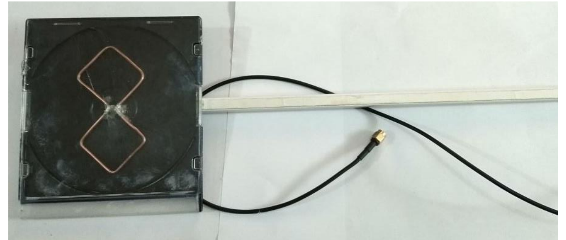
FIGURA 9. ANTENA BIQUAD CONSTRUIDA
