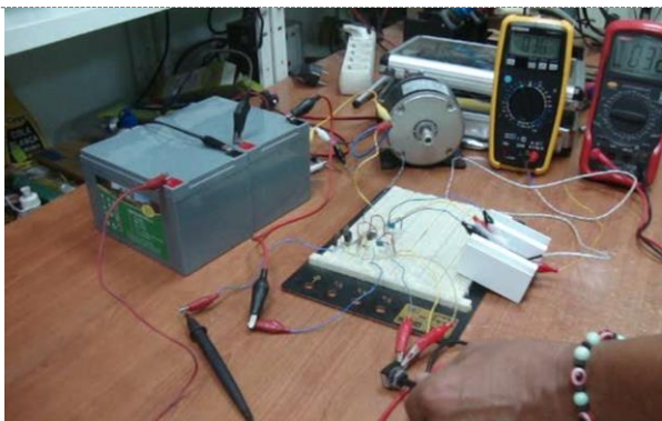
Figura 7. Proceso de Construcción en Protoboard de los circuitos Digitales.
