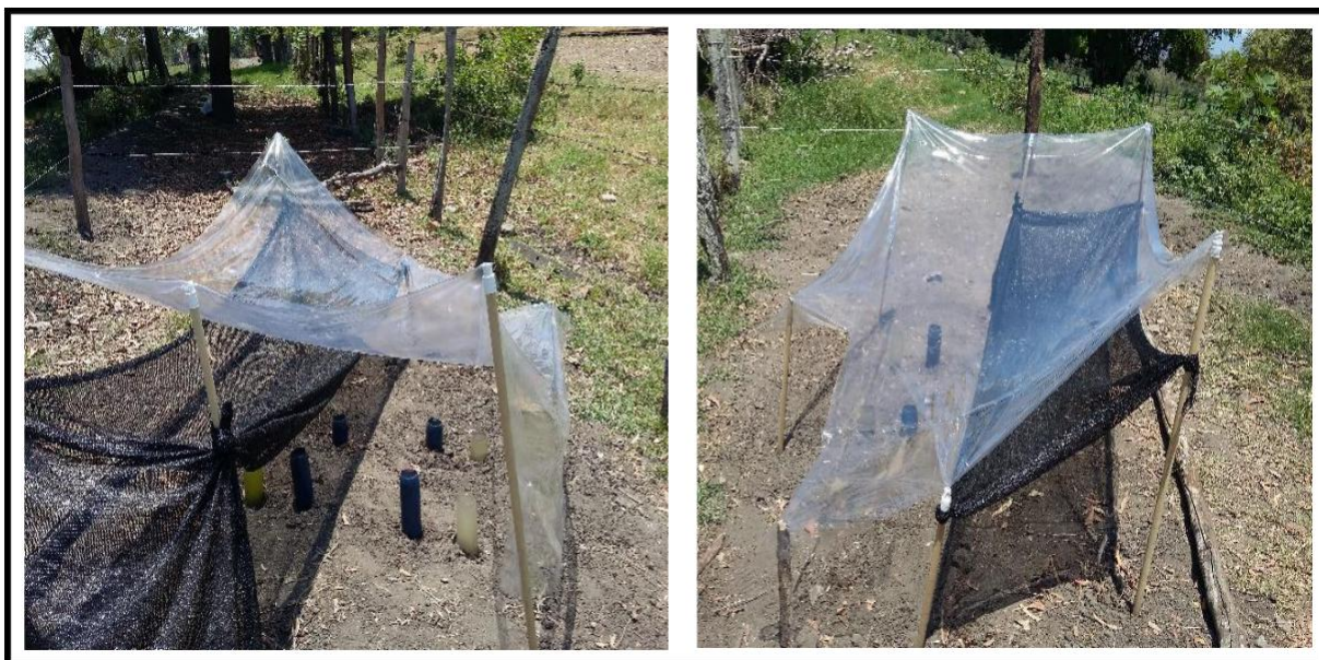
Figura 11. Establecimiento de evaporímetros artesanales.
