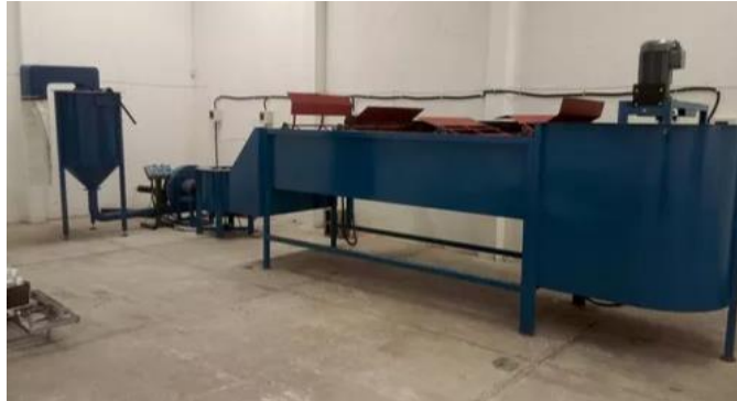
Figura 22: Maquina lavadora y secadora de plástico.
