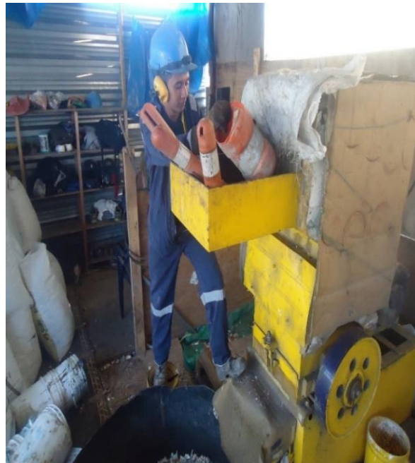
Figura 13: Destrozado de plásticos por medio de sistema mecánico.
