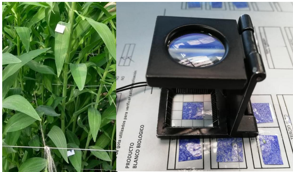
Figura 6 Papales [DH8] hidrosensibles colocados por haz y envés de la planta de Alstroemeria para posteriormente poder hacer conteo de gotas por centímetro cuadrado. (Alfaro, 2019).
