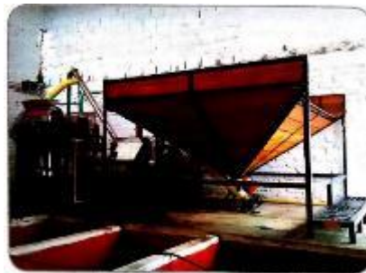
Figura 4. Tolva seca para el recibo de café en cereza en los beneficiaderos (Gast et al. , 2013)
