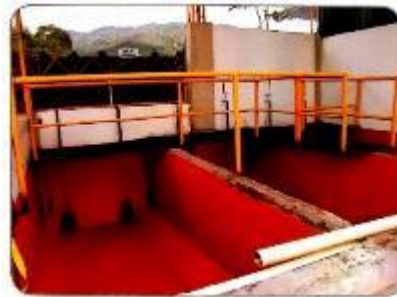
Figura 3. Tolva húmeda para el recibo de café en cereza en los beneficiaderos (Gast et al. , 2013)
