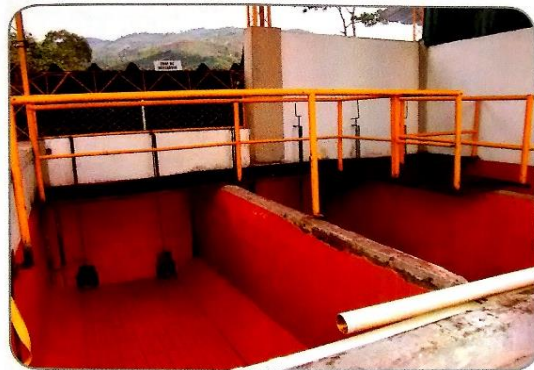
Figura 3. Tolva húmeda para el recibo de café en cereza en los beneficiaderos (Gast et al. , 2013)
