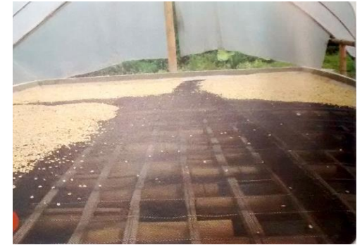
Figura 4. Piso en malla plástica del secador parabólico tipo Cenicafé.
