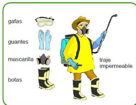
Figura 7. Elementos de protección personal (E.P.P.)
