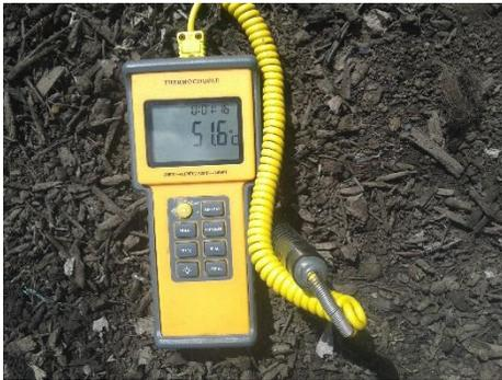
**Figura 10. Termómetro para medir temperatura del sustrato ( Castellanos 2014)**
