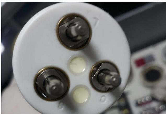
*Ilustración 2, limpieza de cables de alta tensión en el generador a causa de arcos formados en el equipo.*
