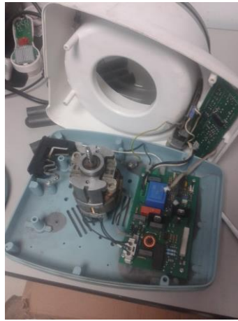
Figura 19 Mantenimiento correctivo. Centrifuga HETTICH EBA20. Fuente: elaboración propia.
