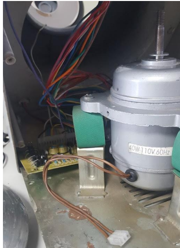
Figura 11 Parte interna de la centrifuga Scientif 80-2B. Fuente: elaboración propia
