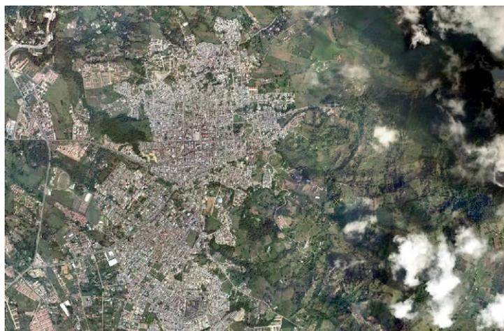
**Fotografía 5:** Ortofotomosaico del municipio de Fusagasugá en el año 2010 a una escala 1:10.000, presenta una resolución de 2,5 cm y fue tomada con la cámara vexón, se observa que el casco urbano del municipio creció considerablemente en comparación al año 1941.
