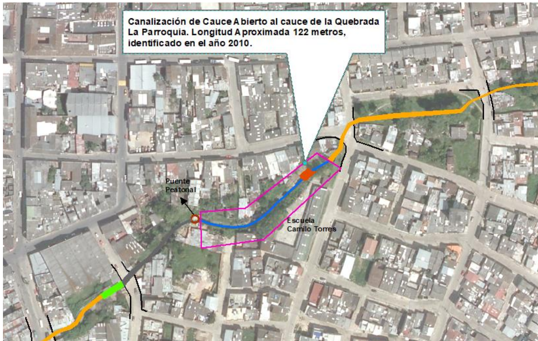
Imagen. 15 Canalización de cauce abierto a la Quebrada La Parroquia. Año 2010.
