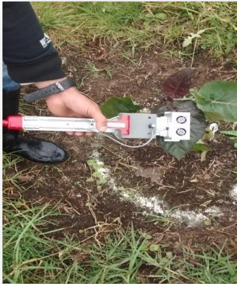
Figura 9 Medida del comportamiento fotosintético (IRGA) y fluorescencia de la clorofila (Fluorómetro) en tomate de árbol ( S. betaceum ) material naranja común (Cotrino y Niño, 2015).
