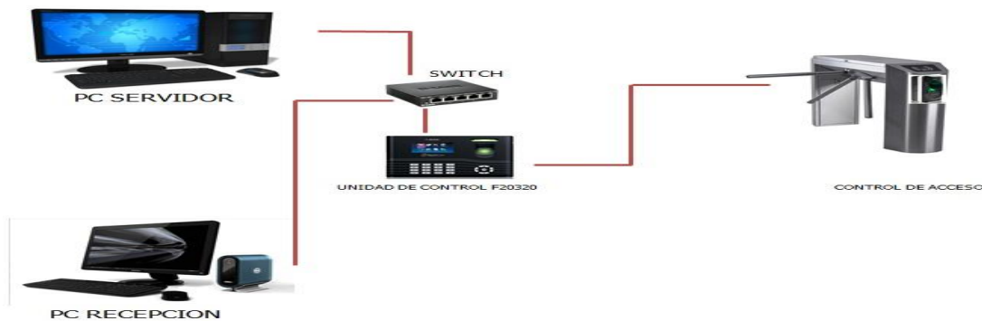
FIGURA 13 SECUENCIA DE FUNCIONAMIENTO DE TORNQUETES CON TECNOLOGÍA RFID
