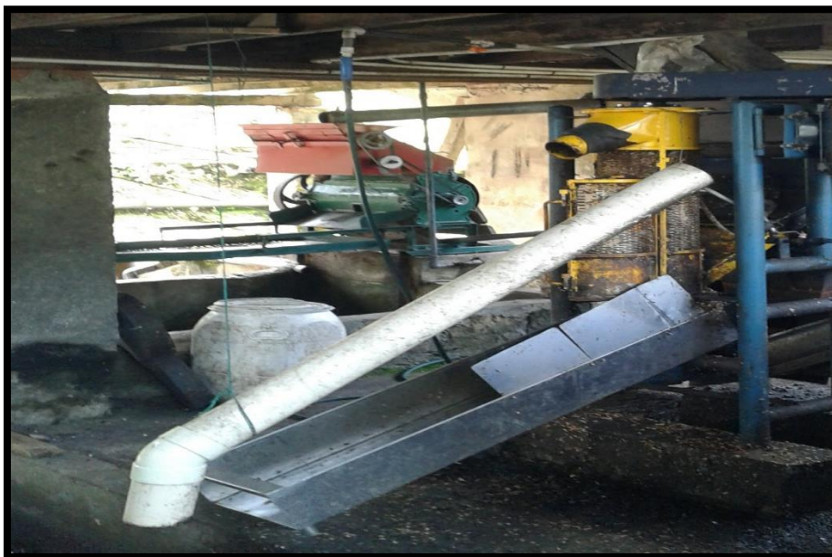
Ilustración 19 Maquina despulpadora tecnificada finca el jardín
