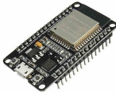
Figura 38. Microcontrolador ESP32 (Fuente: [38].)
