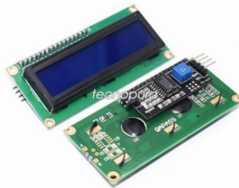
Figura 33. Display LCD 16X2 con modulo I2C (fuente: [35]).
