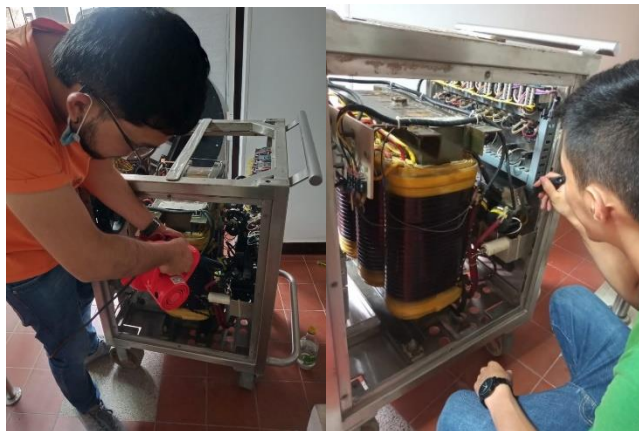
Figura 41. Limpieza de consolas de alivios térmicos.
