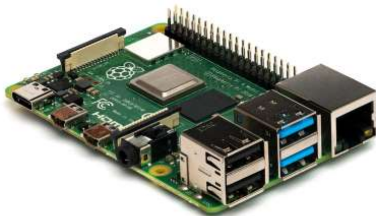
Figura 14. Placa de desarrollo Raspberry Pi modelo 4
