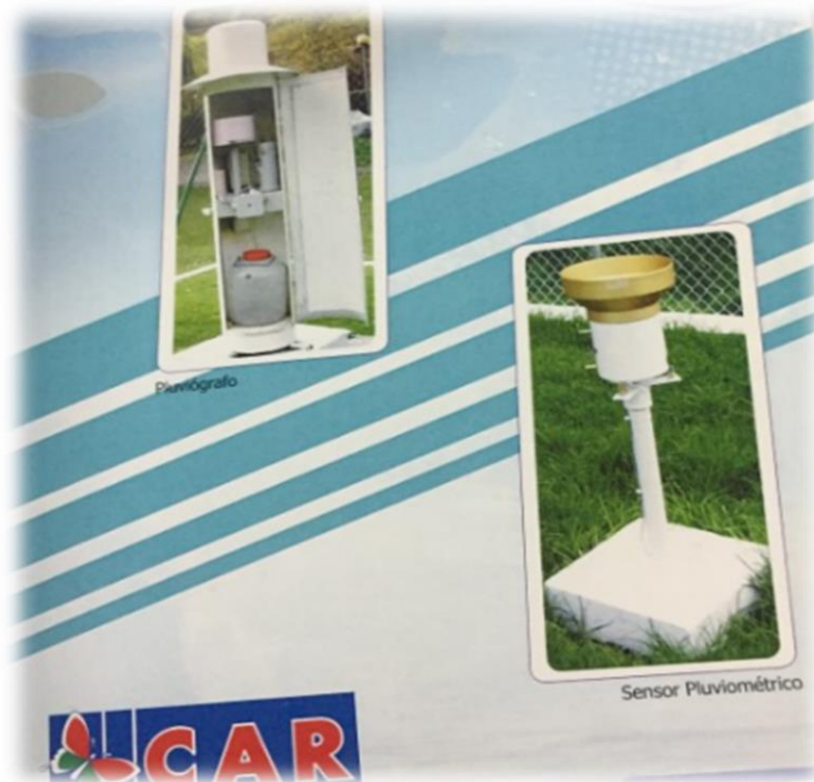
Figura 18. Pluviógrafo y sensor pluviométrico 2009. Fuente: (Izquierdo, 2009)
