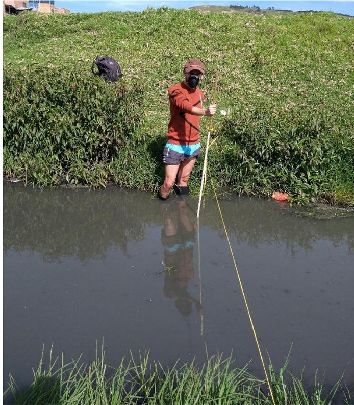
**Figura 14. Medición del área transversal.**
