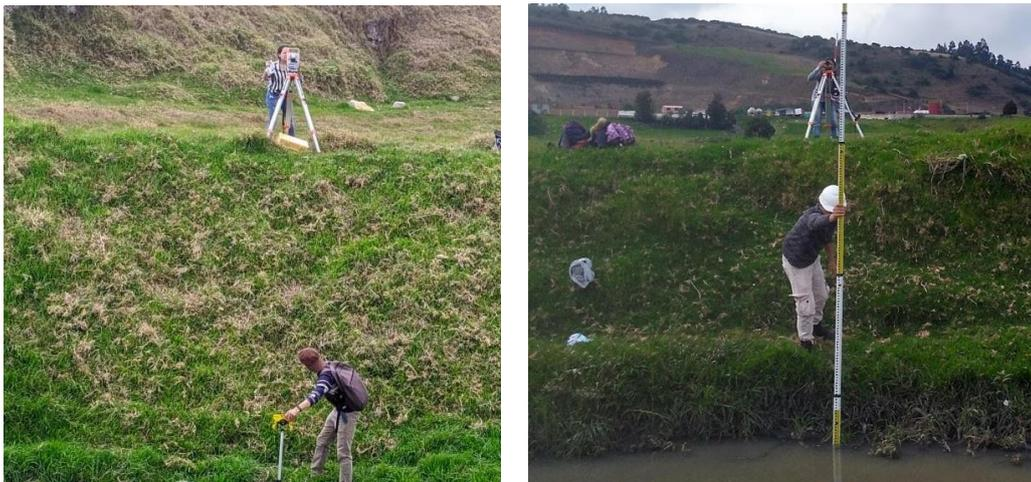
**Figura 13. Batimetría elaborada con estación total (izquierda), y con nivel topográfico (derecha).**
